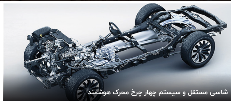
پیشراشه ۲.۰ لیتر هایبرید با سیستم توربوشارژ VGT
